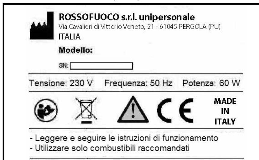
Fig. 2 - Etichette di sicurezza installate sull'apparato
