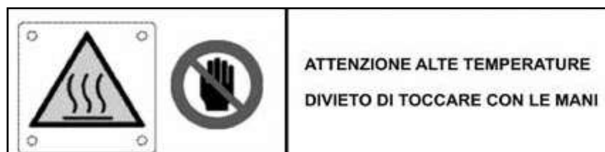
Fig. 2 - Etichette di sicurezza installate sull'apparato
